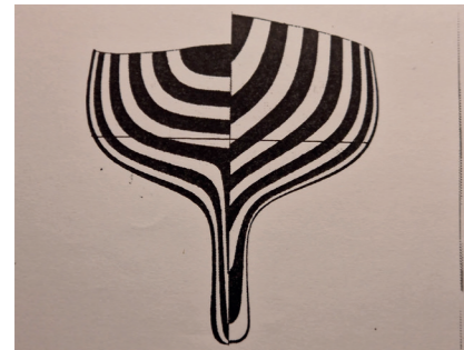
SYS-jakten Winnies spantruta Skarpt förskepp under vattenlinjen och med ett fylligt slag över vattenlinjen. Ger styvhet och rakare linjer vid krängning.
